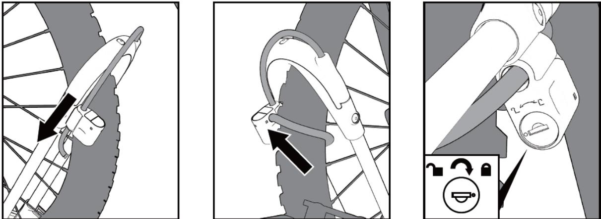
Tirez complètement le câble hors du support de roue avant, fixez-le et bouclez-le autour du tube de cadre du vélo et/ou à travers la roue avant et insérez l'extrémité dans le boîtier de serrure coulissant librement avec cylindre de serrure. Verrouillez le cylindre de serrure pour retarder le vol. Veuillez conserver soigneusement cette clé.
