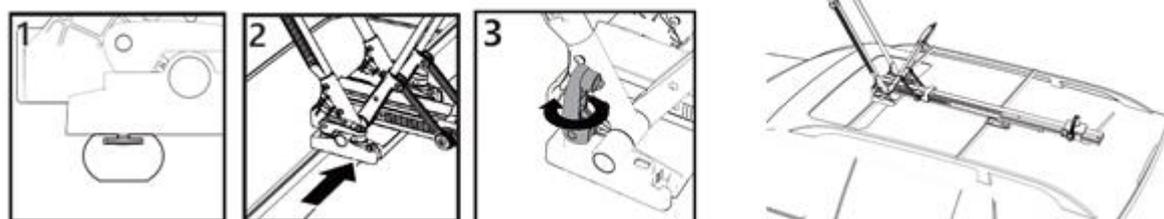
Placez les boulons en T dans les profilés de support en aluminium (1), faites glisser le support dans la position souhaitée (2), desserrez/serrez les leviers de serrage rapide pour la force de fermeture souhaitée (3) et fermez-le en le rabattant.
