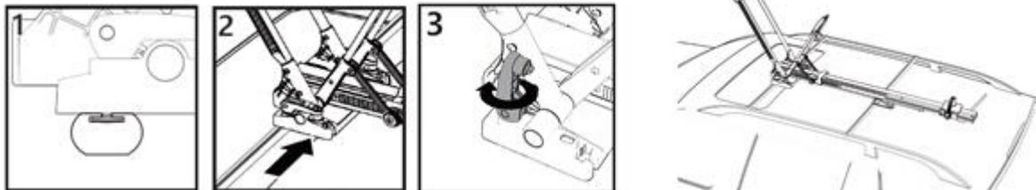
Setzen Sie die T-Bolzen in die Aluminium-Trägerprofile ein (1), schieben Sie den Träger in die gewünschte Position (2), lösen/festen Sie die Schnellspannhebel für die gewünschte Schließkraft (3) und schließen Sie ihn durch Herunterklappen.
