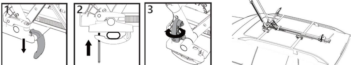
Haak de 3x beugels in de drager (1), plaats de spanbouts 2x lang voor 1x kort achter, sluit de beugels om de dragerprofielen (2), draai de snelspanhevels los/vast voor de gewenste sluitkracht (3) en sluit door deze naar te klappen.
