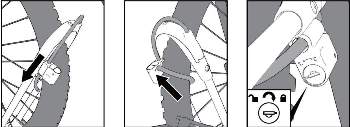
Trek de kabel volledig uit de voorwielsteun, bevestig deze in en lus om de framebuis van de fiets en/of door het voorwiel en steek het uiteinde in het vrij verschuifbare slothuis met slotcilinder. Sluit de slotcilinder af om diefstal te vertragen. Bewaar de sleutel zorgvuldig.
