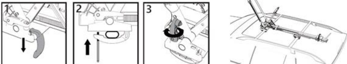
3x Halterungen in den Träger einhängen (1), Spannbolzen 2x lang vorne, 1x kurz hinten platzieren, Halterungen um die Trägerprofile schließen (2), Schnellspannhebel lösen/festen bis gewünschte Schließkraft (3) und schließen.
