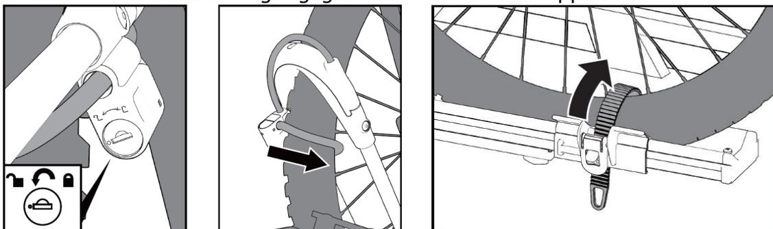
Klappen Sie die kleine Vorderradstütze nach hinten und nehmen das Fahrrad ab.
