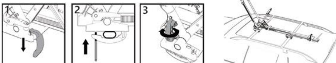
Accrochez les 3x supports dans le support (1), placez les boulons de tension 2x longs devant et 1x court derrière, fermez les supports autour des profilés de
