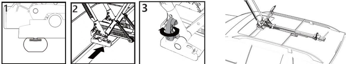
Plaats de T-bouten in de aluminium dragerprofielen (1), schuif de drager naar de gewenste positie (2), draai de snelspanhevels los/vast voor de gewenste sluitkracht (3) en sluit door deze naar te klappen.
