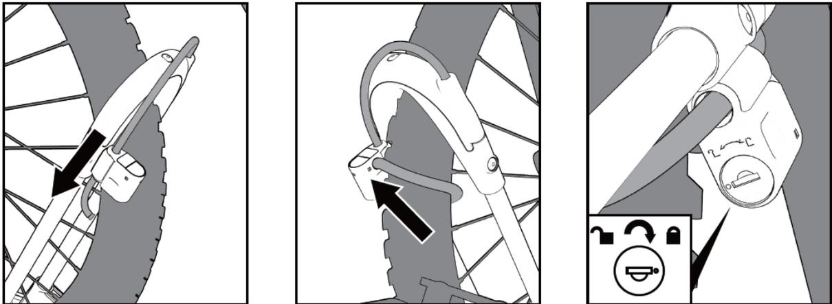
Ziehen Sie das Kabel vollständig aus der Vorderradhalterung, befestigen Sie es und schlingen Sie es um das Rahmenrohr des Fahrrads bzw. durch das Vorderrad und führen Sie das Ende in das frei verschiebbare Schlossgehäuse mit Schließzylinder ein. Verriegeln Sie den Schließzylinder, um einen Diebstahl zu verzögern. Bewahren Sie den Schlüssel sorgfältig auf.
